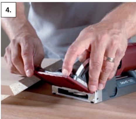
4. Plaats de schuininstelbare aanslag op 60° en monteer het opsteekplaatje van 4 mm
