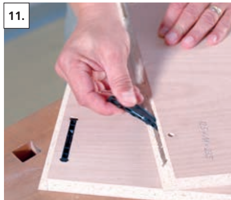
11. Clamex P delen inschuiven zonder werktuig
