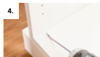
4. Meubelelementen met accuschroevendraaier en Cabineo gereedschap met elkaar verbinden. Eenvoudig en snel werken met vooraf ingesteld draaimoment van ca. 2,5 Nm.
