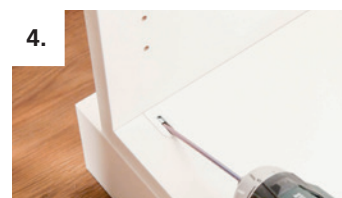
4. Meubelementen met accuschroevendraaier en Cabineo gereedschap met elkaar verbinden. Eenvoudig en snel werken met vooraf ingesteld draaimoment van ca. 2,5 Nm.
