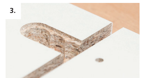
3. Omtrek van Cabineo afdekkap infrezen
