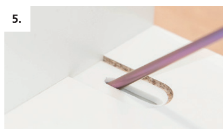
5. Werkstukken verbinden met behulp van accuschroevendraaier (draaimoment ca. 2,5 Nm)
