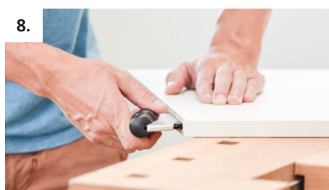
8. Divario P-18 in de zijkanten van het frame en in de plank monteren
