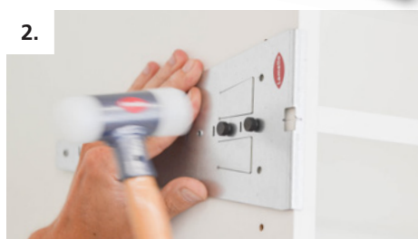
2. Markeermal tegen de voorkant plaatsen en boorgaten markeren
