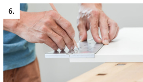
6. Midden van de verbinder op de plank aftekenen
